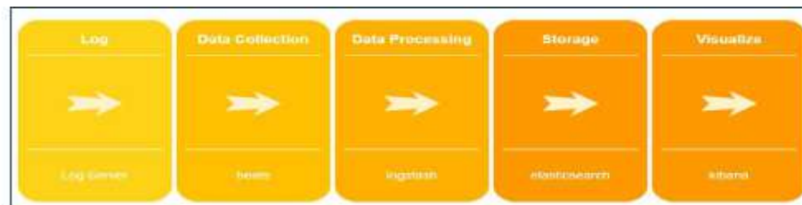
รูปที่ 5 แสดงกระบวนการทำงาน Elastic Stack
