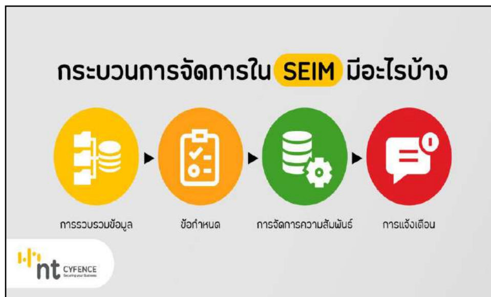
ภาพประกอบที่ 2.23 แสดง กระบวนการทำงานของ SIEM มีอะไรบ้าง ที่มา : Cyfence.com, 2022
